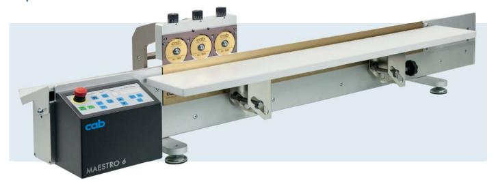
Séparation sans contraintes de circuits à rainures de séparation jusqu'à 1500 mm de long.
