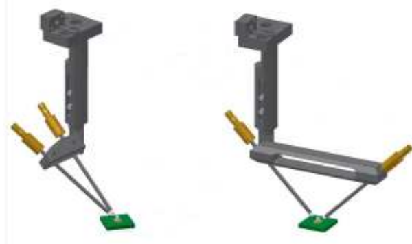
Double avance de fil sur tête inclinée (guides fil placés du même côté ou en opposition)
