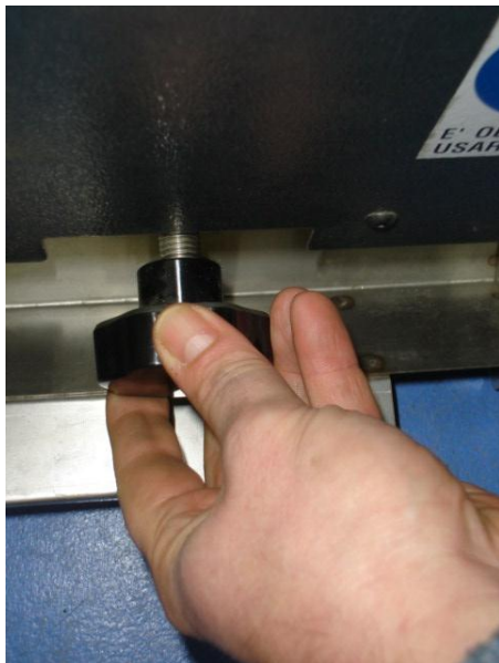
Robinet de Purge
