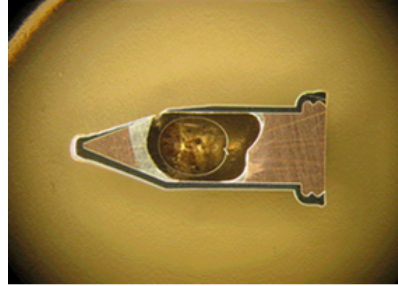
Coupe transversale d'une panne usée Formation d'un trou
